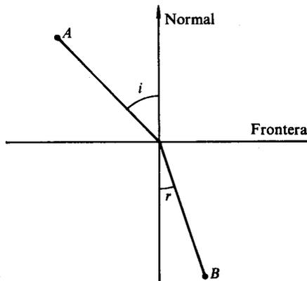
Con base en este principio, demuéstrase que, al pasar la luz de un medio a otro, los *ángulos de incidencia* y de *refracción* se relacionan de la manera siguiente:
